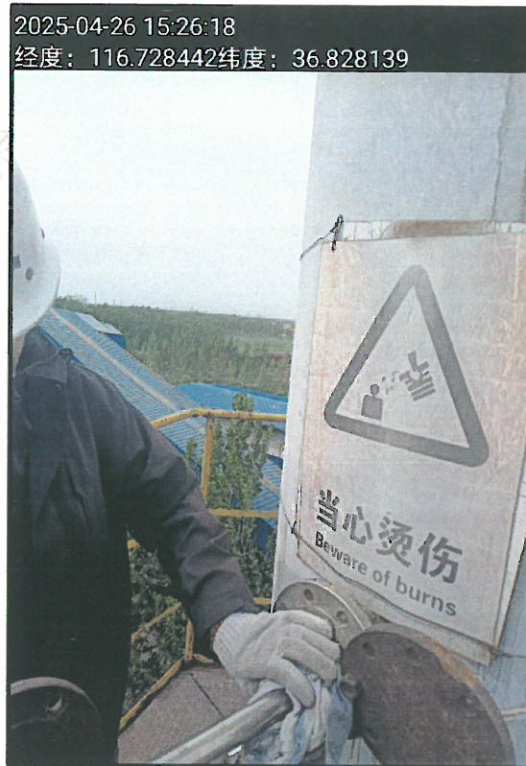
附图：对甲酚碱熔处理设施后废气采样
